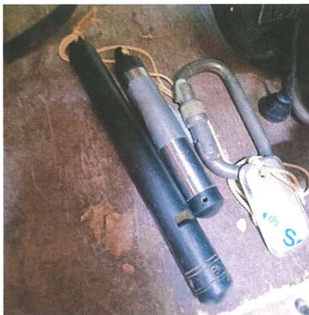
Obrázek č. 26 – Levelloggerová čidla, zleva L 200, Junior
