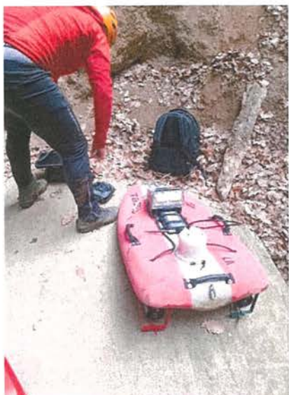
Obrázek č. 13 plovák provádějící Acoustic Doppler Current Profile, Obrázek č. 14 3D skener Leica
