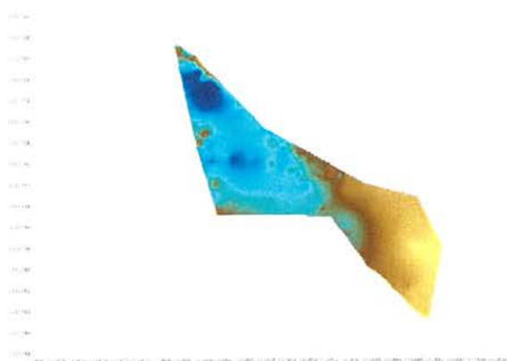
2024: Bythymetrie Jezírka na základě měření ADCP z ČHMÚ
