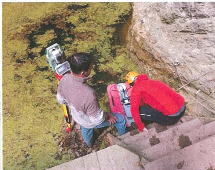
Obrázek č. 13 plovák provádějící Acoustic Doppler Current Profile, Obrázek č. 14 3D skener Leica
