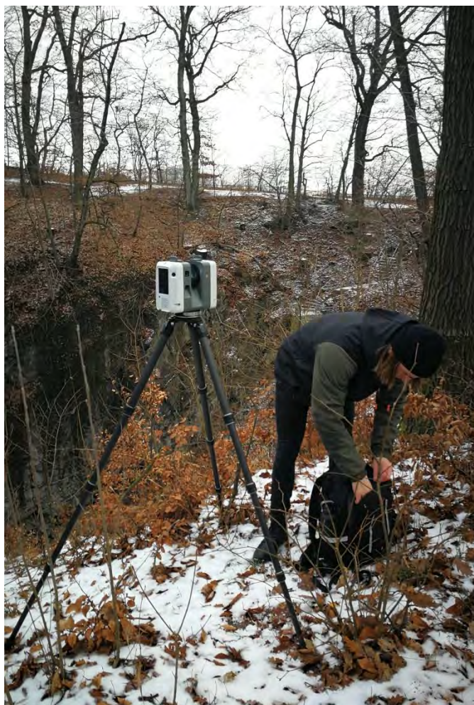
Obrázek č. 2 – Ohlubeň propasti, 3D skener LEICA RTC 360
