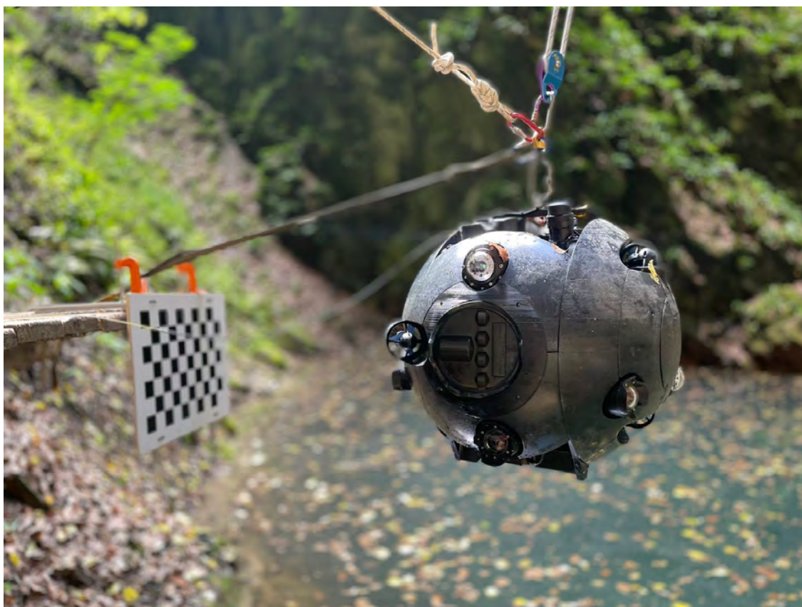
Obrázek č.9 – Podvodní robot pře ponorem, zavěšený před kalibrační šachovnici na plošině u Jezírka.
