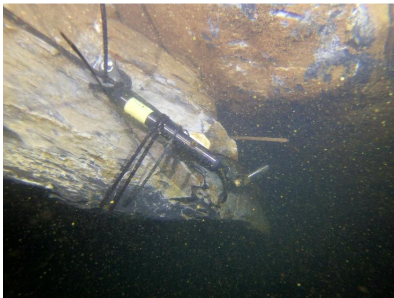
Nově umístěný horolezecký nýt na přední hraně Zubatice s Levelloggerovým čidlem M 200
