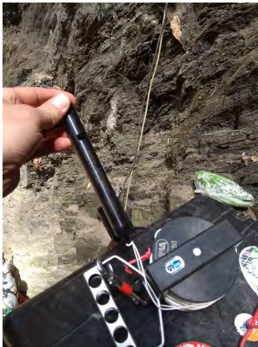
Levelloggerové čidlo umístěné na vodící šňůře speleocívky LOLA
