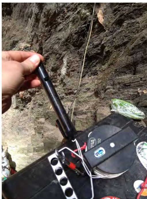
Levelloggerové čidlo umístěné na vodící šňůře speleocívky LOLA, která je umístěna v prostorách Helmy, ze které je čidlo spuštěno do prostor Liftu I -130m hloubky.
