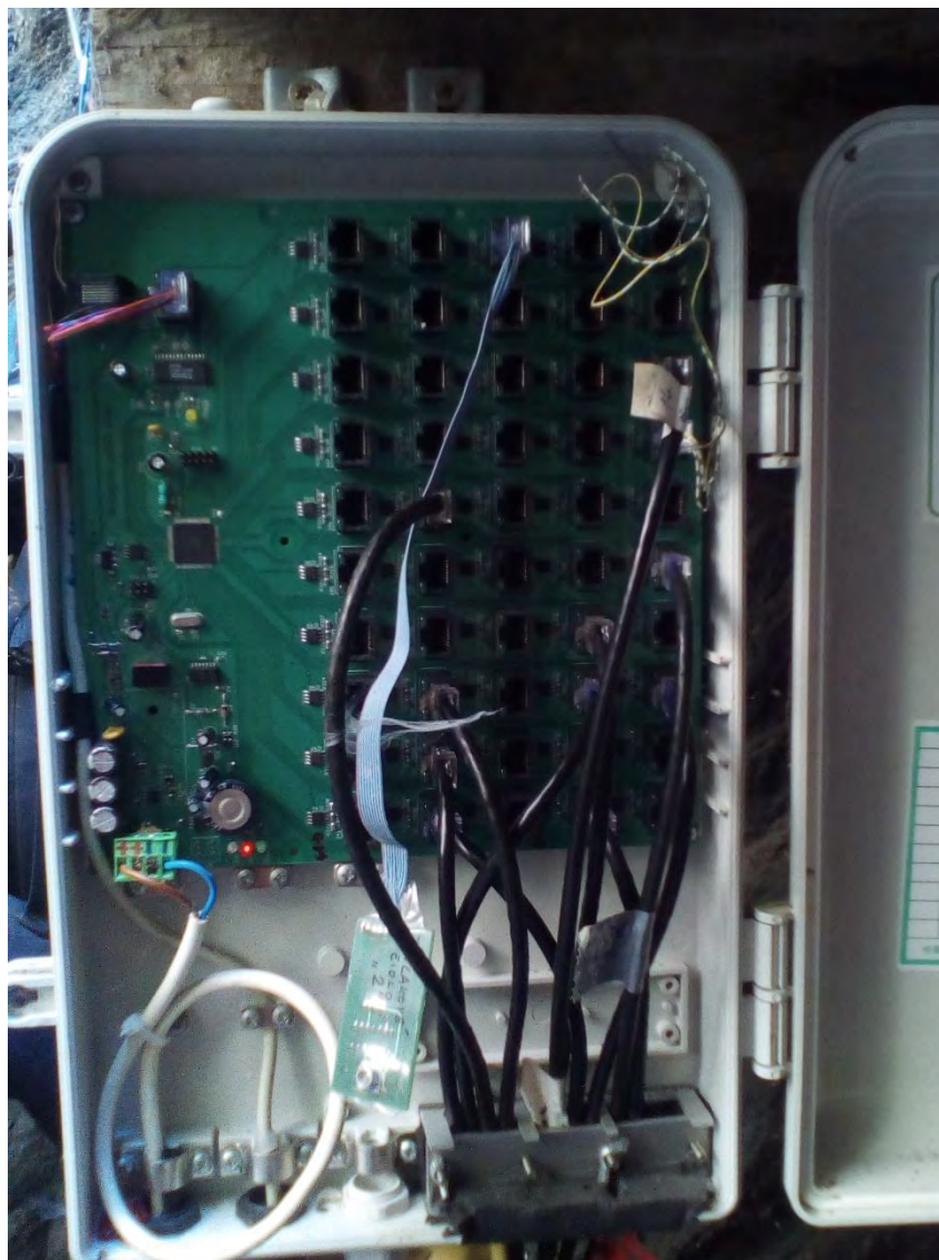
Ústředna teplotních čidel, umístěná na plošině u Jezírka.
