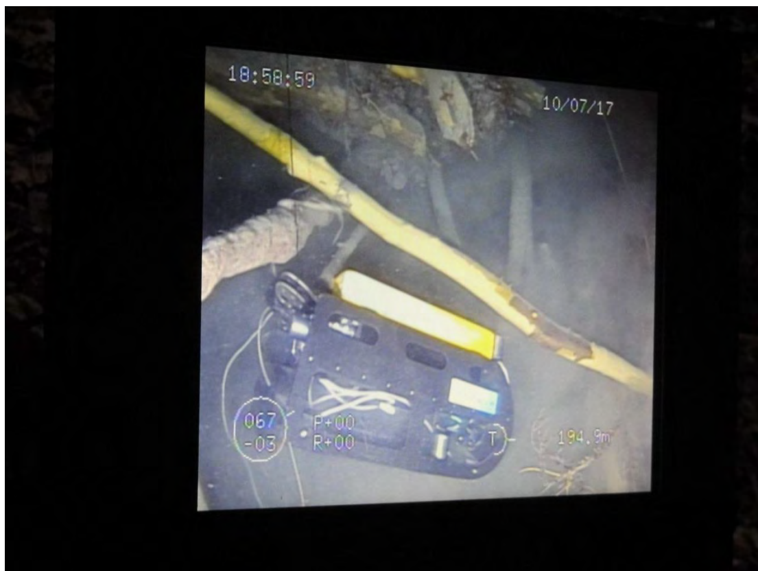
Nalezený „zaklíněný“ robot fy. GRALmarine ve 195m hloubce. Foto z monitoru robota Falcon.
