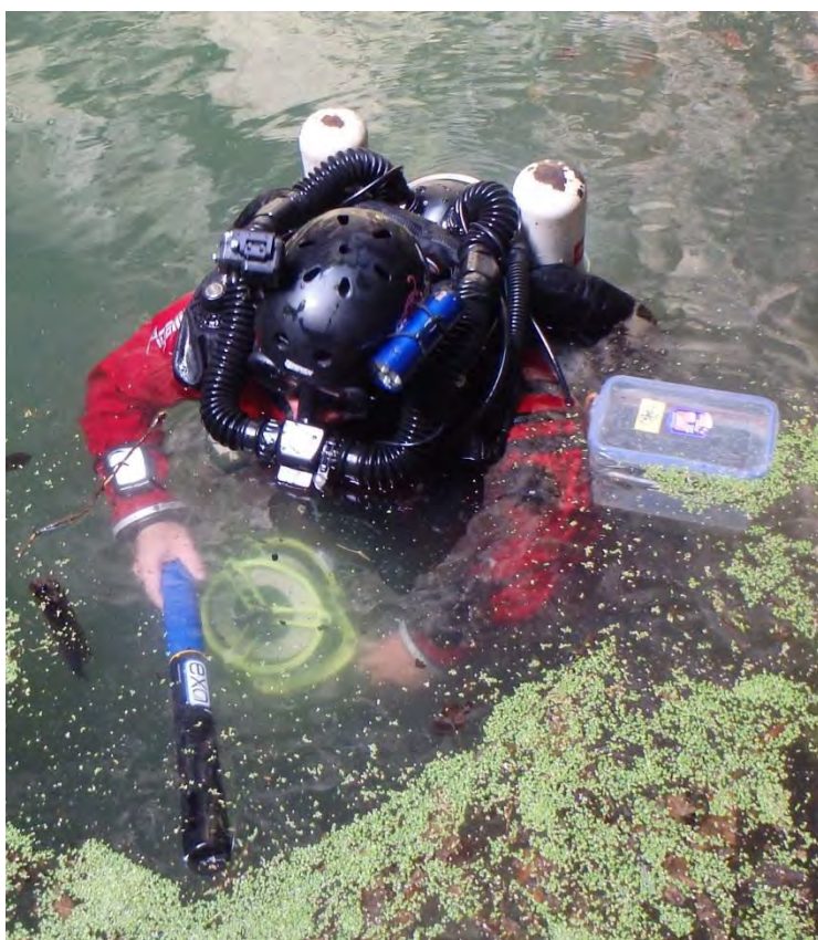
Obr.Vysoká_HP_2 Potápěč (David Čani) s EXOsondou a vzorkovnicí na odběr vody z hloubky 130 m. Foto Helena Vysoká
