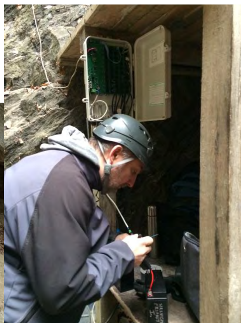
Vladan Mickerts při výměně baterie ústředny sběru dat.
