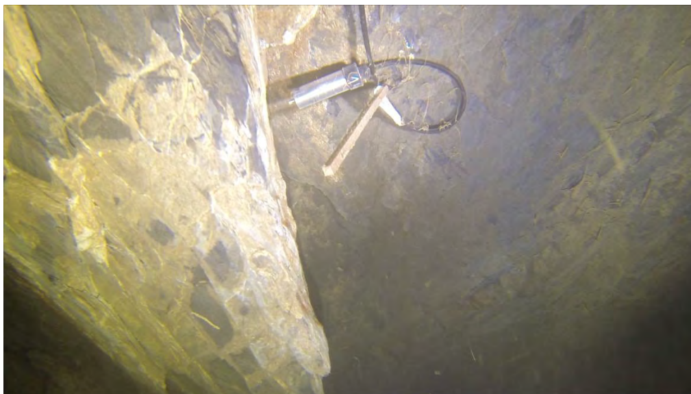
Teplotní čidlo v prostorách Helmy (-48m).
