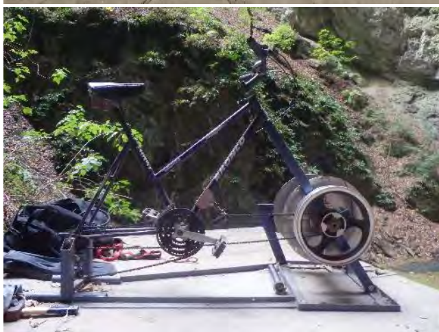
Obr Vysoká_HP_13 Hlubkový odběrák - pro odběr vzorku vody z hloubky 180 m. Ovládá se z hladiny. Autoři: Miroslav Lukáš, Tomáš Ježek, LOLA. (foto H. Vysoká)
