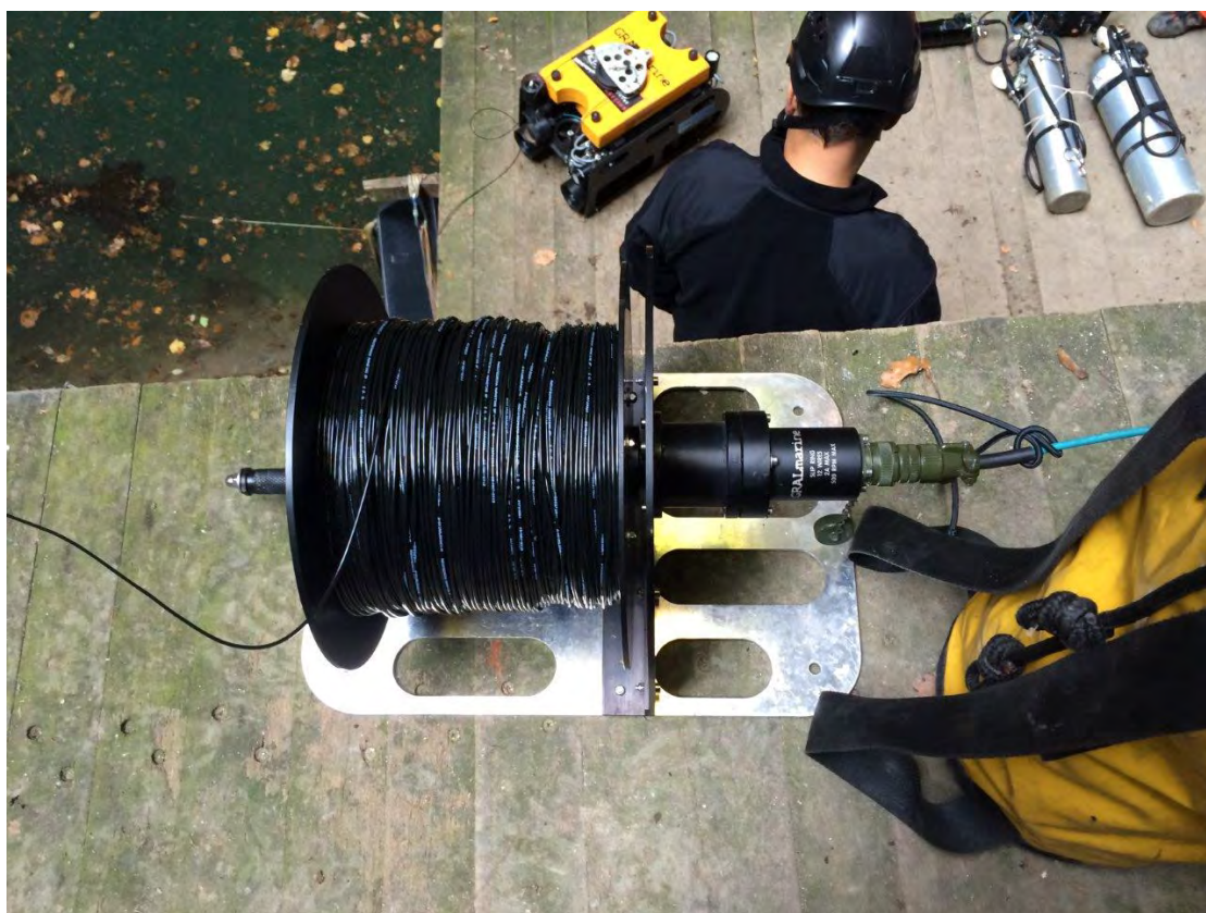
Navíjecí cívka - buben s komunikačním optickým kabelem podvodního robota – cca 500m.
